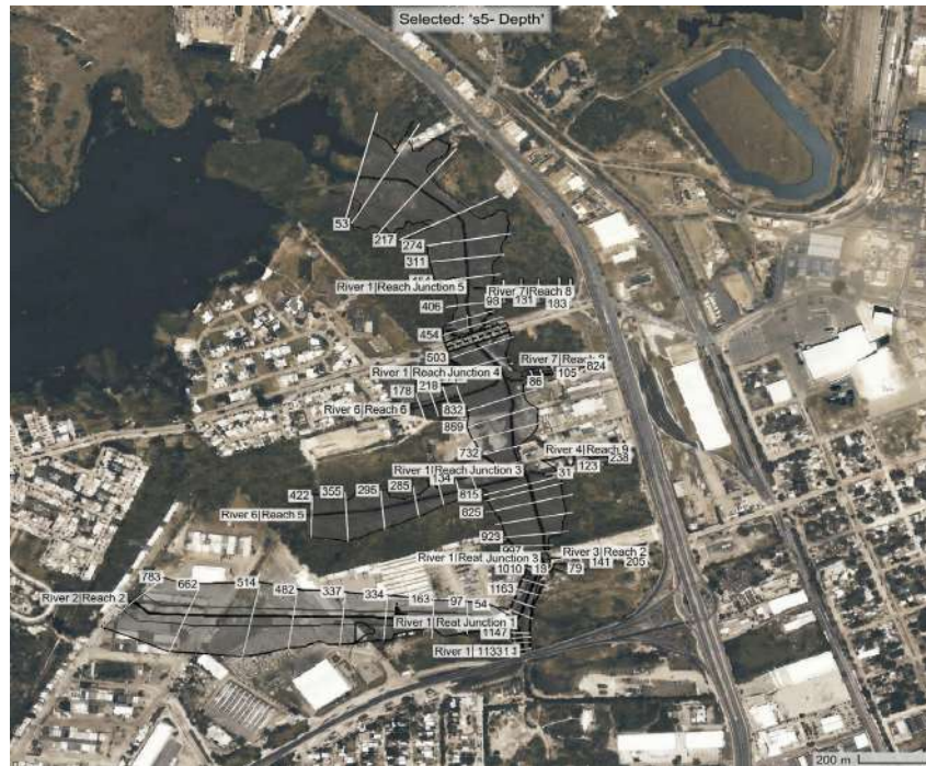
Figura 6. Representación espacial de la llanura de inundación asociada a un período de retorno de 50 años. El sombreado indica las áreas con mayor exposición al riesgo de inundación
